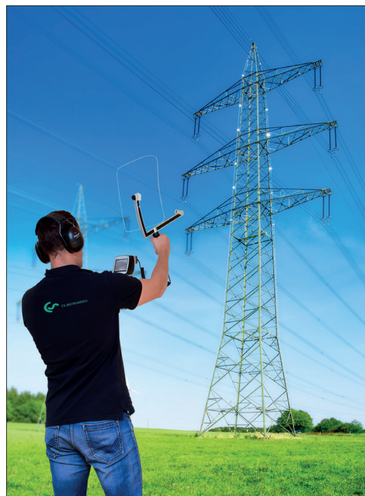
Kontrola przewodów wysokiego napięcia w poszukiwaniu wyładowań koronowych.
